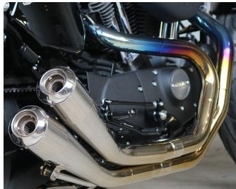
スチールやステンレスに勝る耐腐食性(耐錆)と軽量化が大きなアドバンantageのチタニウムをマテリアルとする、走りにこだわるTRAMPのエキゾーストシステム(エンドチップのみステンレス)。
